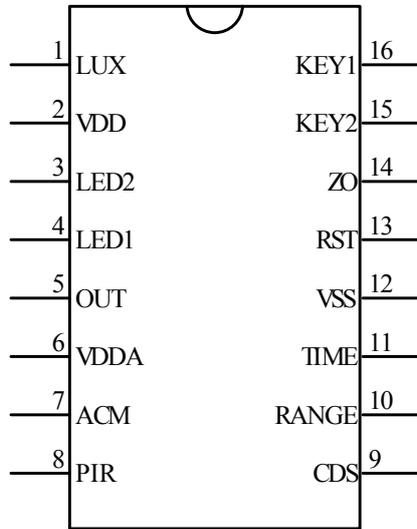
圖 1 RC664102 封裝 SOP16 引腳圖
